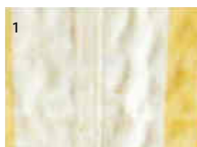
Wickelfalten neben einer Naht Winding creases close to a seam
